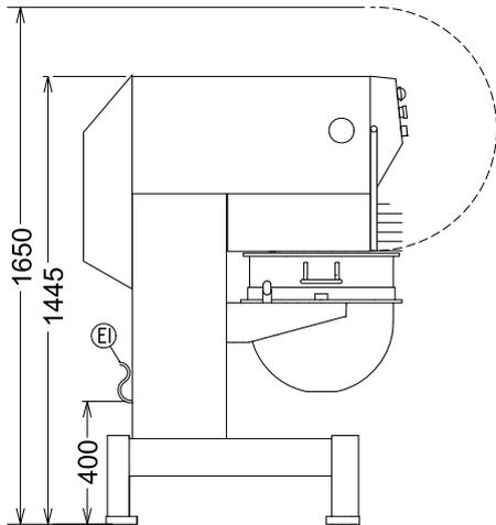
EI = Conexión eléctrica (energía)
